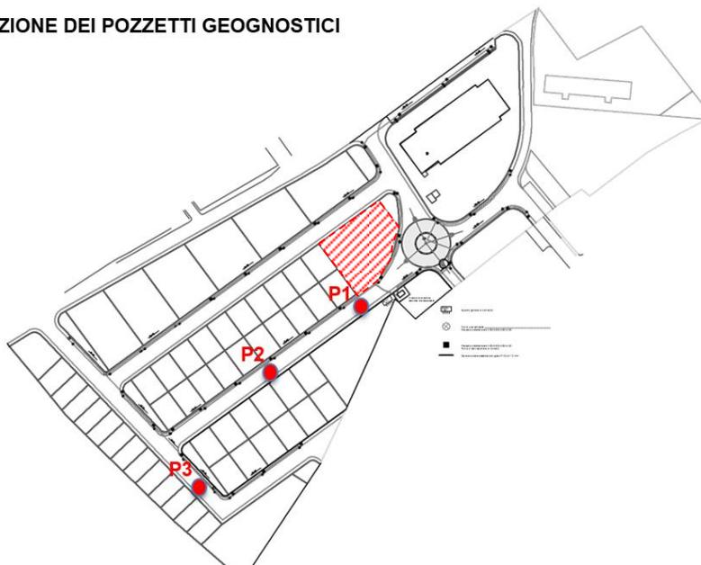
Figura 6.1- Planimetria delle indagini eseguite per i lavori di riqualificazione urbana del centro abitato – Area Ex P.E.E.P e area di intervento.
