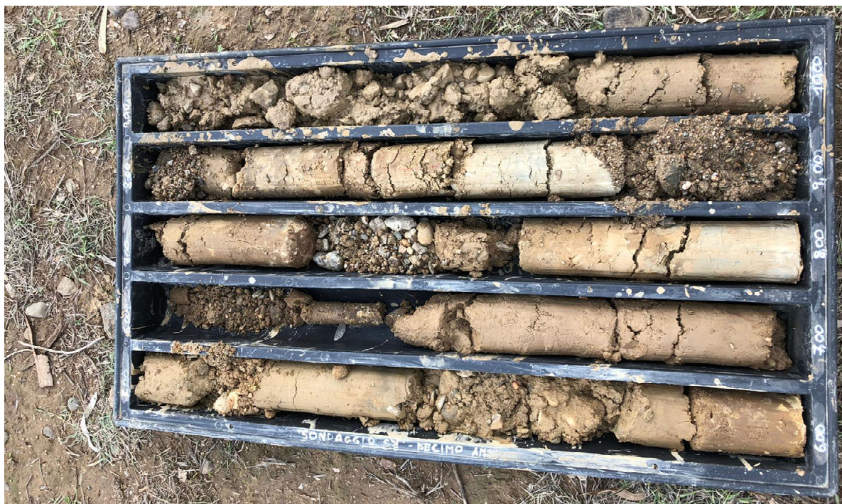
Fig. 14: Testimoni prelevati in corrispondenza delle aree sistemate a ridosso del Rio Flumini Mannu – Profondità 5.00 m – 10.00 m
