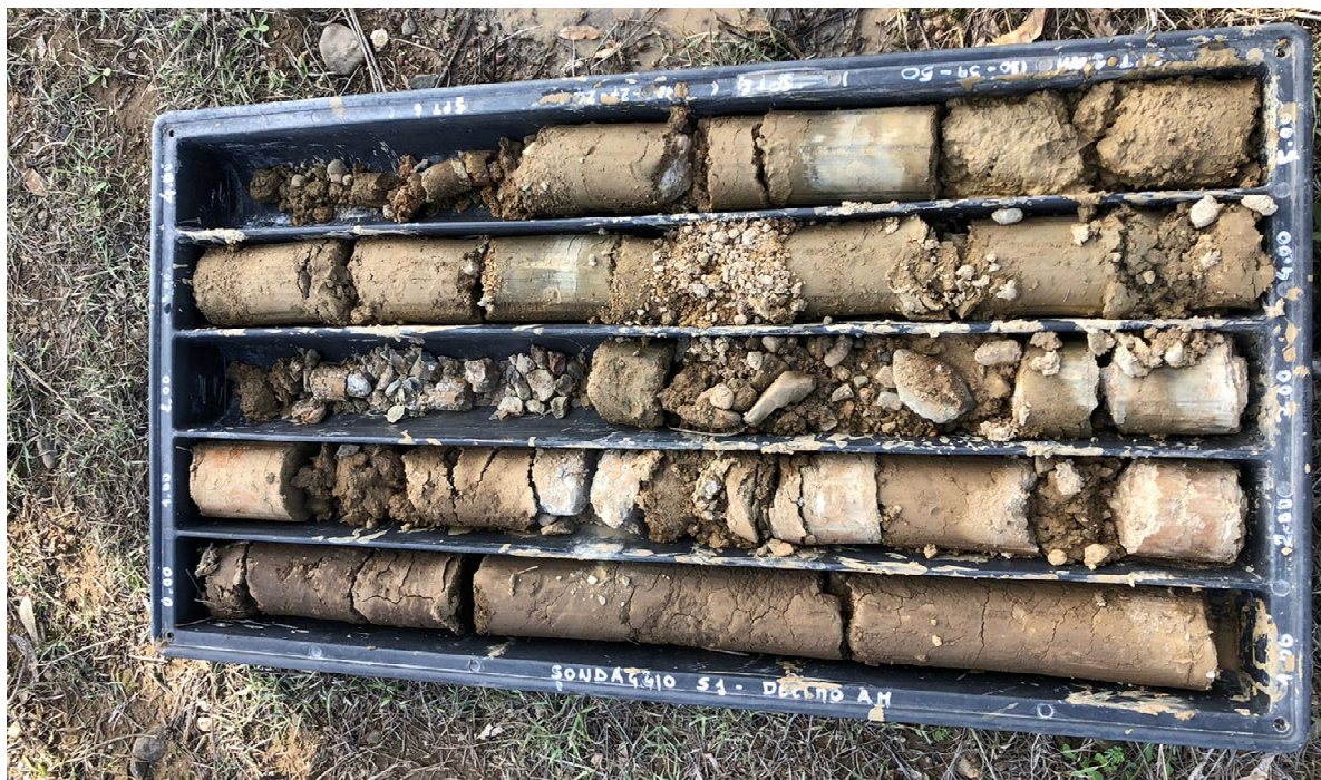
Fig. 13: Testimoni prelevati in corrispondenza delle aree sistemate a ridosso del Rio Flumini Mannu – Profondità 0.00 m – 5.00 m
